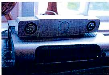
CENTRALENHET MED HÖGTALARE. Enheten läser upp alla Bertils värden för att sedan skicka dem vidare för avläsning på hemtjänsten eller inom primärvården.
